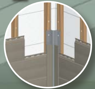
Dokončení vnitřního rohu (hrany) profilu
